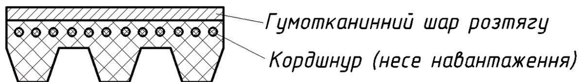
Рисунок 10.7 – Переріз поліклинового паса
